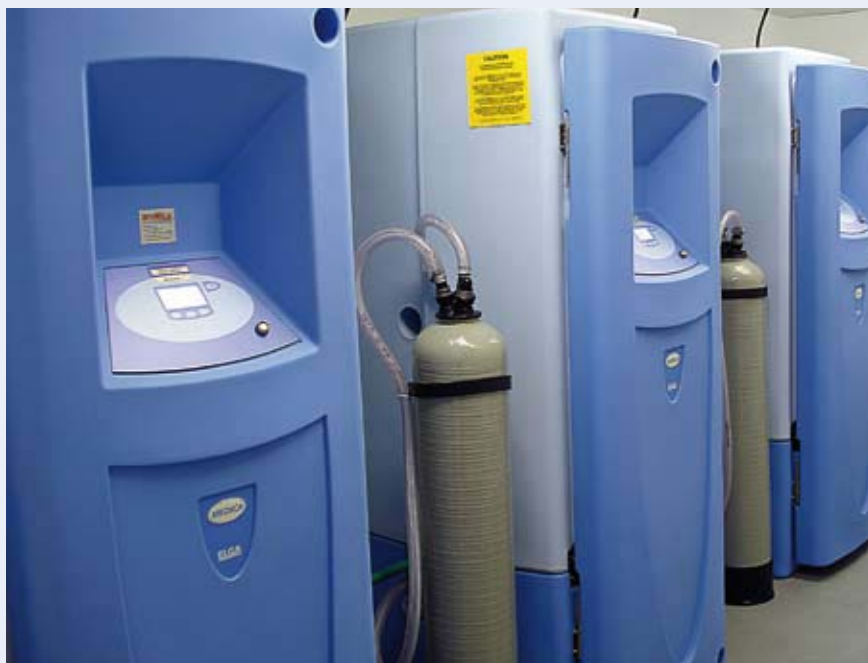
Cada sistema de purificação produz até 200 litros de água ultrapura por hora
